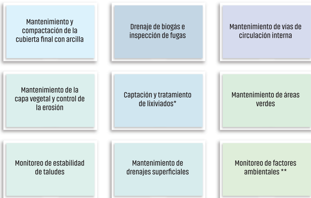
Figura 47. Proceso de cierre relleno sanitario de Normandía
